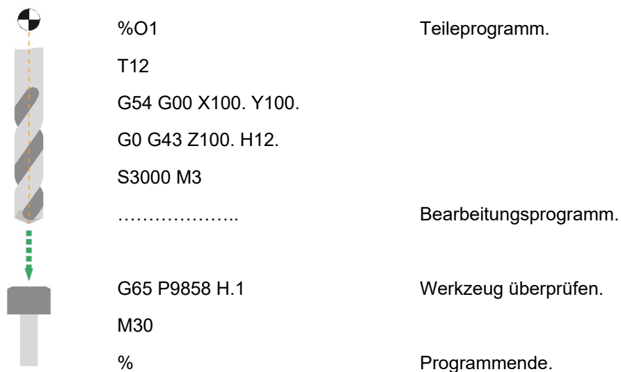
Abbildung 6.2 Überprüfung eines Bohrers
